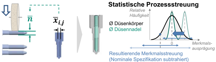
Abbildung 2-19: Prinzipdarstellung der statistisch adaptiven Fertigung und resultierenden Merkmalsstreuung am Beispiel des Passungsspiel im Düsenmodul, eigene Darstellung
