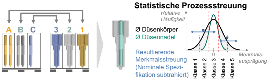
Abbildung 2-17: Prinzipdarstellung der selektiven Montage und resultierenden Merkmalsstreuung am Beispiel des Passungsspiels im Düsenmodul, eigene Darstellung
