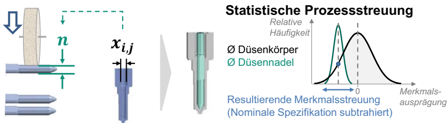
Abbildung 2-20: Prinzipdarstellung der individuellen Fertigung und resultierenden Merkmalsstreuung am Beispiel des Passungsspiels im Düsenmodul, eigene Darstellung
