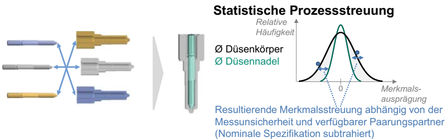
Abbildung 2-18: Prinzipdarstellung der individuellen Montage und resultierender Merkmalsstreuung am Beispiel des Passungsspiels im Düsenmodul, eigene Darstellung
