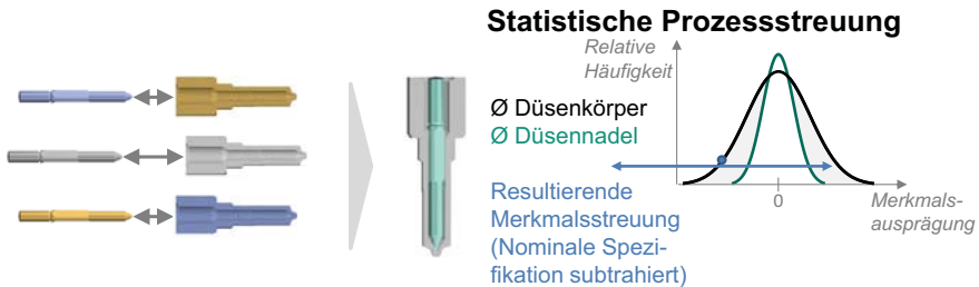
Abbildung 2-16: Prinzipdarstellung der konventionellen Montage und resultierenden Merkmalsstreuung am Beispiel des Passungsspiels im Düsenmodul, eigene Darstellung
