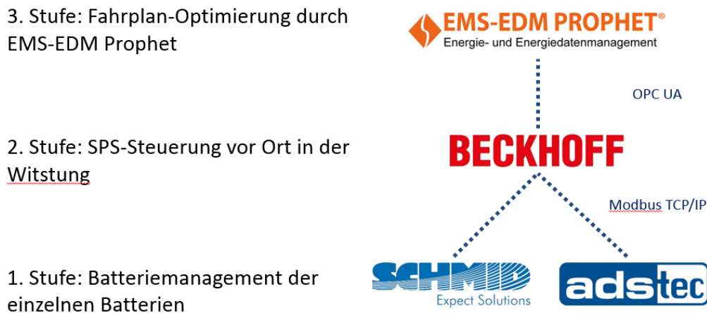
Bild 8: Darstellung der Steuerungsebenen und Schnittstellen
