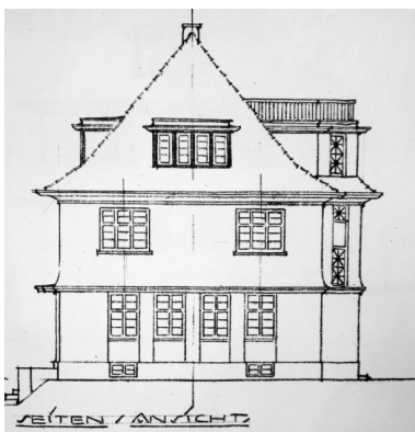
Abbildung 45: Bauzeichnung des Lotsenhauses: Seitenansicht Nordseite
