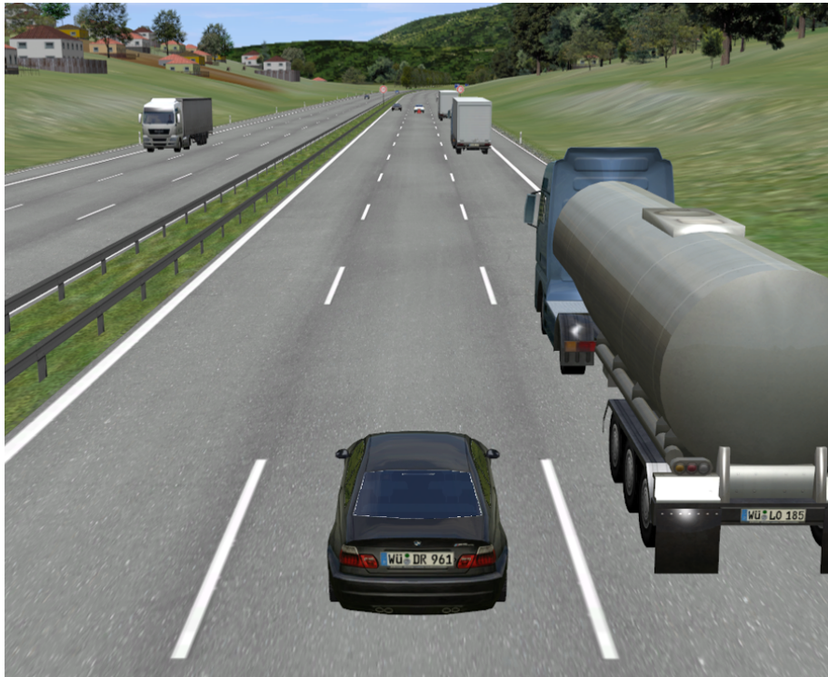
Abbildung 5.18: Umgebungssituation zum Zeitpunkt der Übernahmeaufforderung. Ein Pannenfahrzeug steht 200 m entfernt auf der mittleren Spur. Die rechte Spur ist in diesem Fall durch LKWs blockiert.
