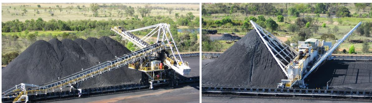
Abb. 3: Absetzer<sup>2</sup> (links) und Brücken-Kratzer<sup>3</sup> (rechts)
