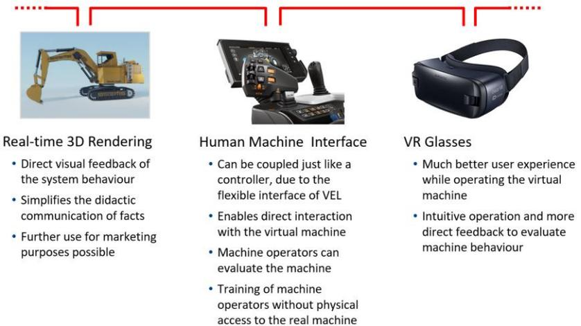
Abbildung 6.2: Beispiele ergänzender Visualisierung und HMI-Geräte.
