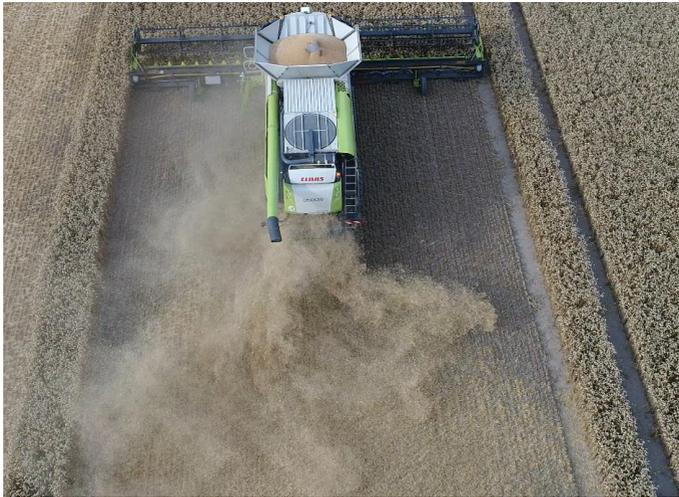
Abbildung 1.1: Luftaufnahme eines LEXION mit Radialverteiler bei der Ernte mit Seitenwind.
