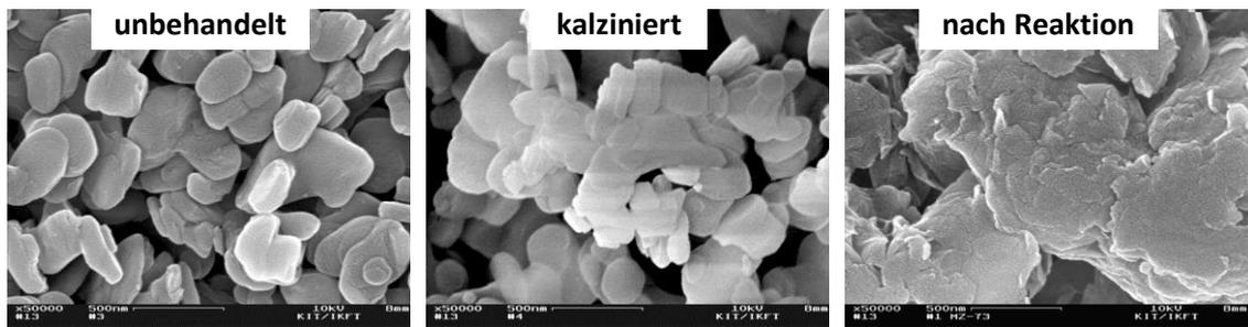
Abbildung 3.14: REM-Aufnahmen des Katalysators Hydrotalkit sowie des Feststoffrückstands nach Isomerisierung in 50000-facher Vergrößerung, Reaktionsbedingungen:  $T = 100\text{ }^{\circ}\text{C}$ ,  $t = 40\text{ min}$ ,  $\text{pH} = 2$ , Luftatmosphäre,  $m_{\text{Kat}}/m_{\text{Gluc}} = 0,2$
