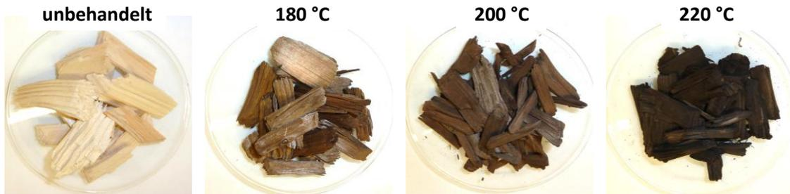
Abbildung 2.14: Fotografien des unbehandelten Fichtenholzes und der Feststoffrückstände nach Hydrolyse mit 0,05 mol/l  $\text{H}_2\text{SO}_4$  bei verschiedenen Temperaturen
