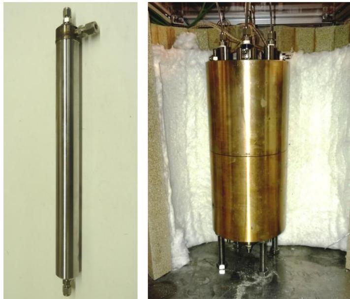
Abbildung 4.6: Strömungsrohr-Reaktor der Laboranlage zur Synthese von HMF (links), in Messing-Heizblock eingesetzte Reaktoren (rechts)
