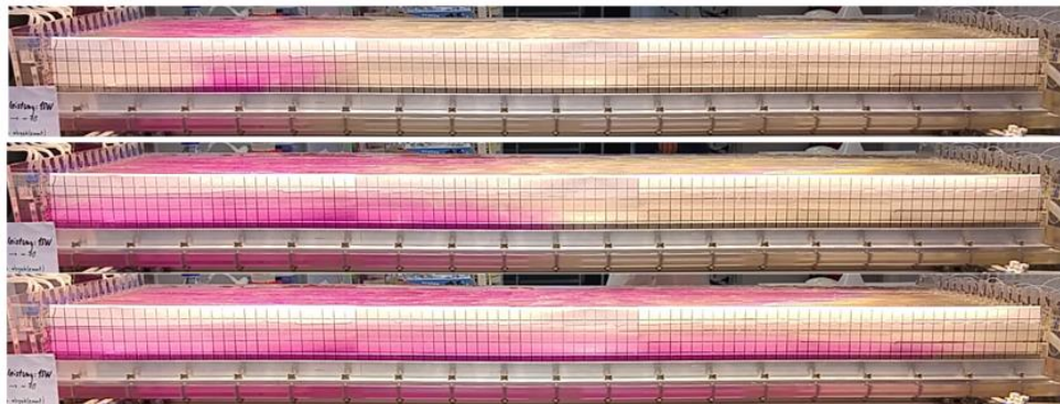
Abbildung 0.16: Mit Phenolphthalein und einem pH-Shift visualisierte Strömung längs des Zick-Zack-Reaktors; Durchmischung einer Lamelle bei Sekunde 4, 15 und 40. \dot{V}_L = 22,8 \text{ L}\cdot\text{min}^{-1} , \bar{v}_L = 0,015 \text{ m}\cdot\text{s}^{-1}
