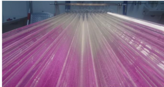
Abbildung 0.17: Mit Phenolphthalein und einem pH-Shift visualisierte Strömung des Zick-Zack-Reaktors von oben
