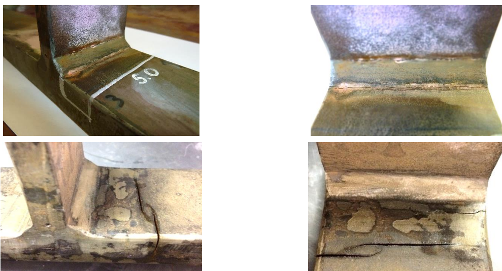
Abbildung 45: Exemplarische Versagensbilder der Serie Quersteife HFH-behandelt (Q_HFH_KMW_B) mit Rissausgang in der Schweißnaht (oben) und Rissausgang im Grundwerkstoff (unten)
