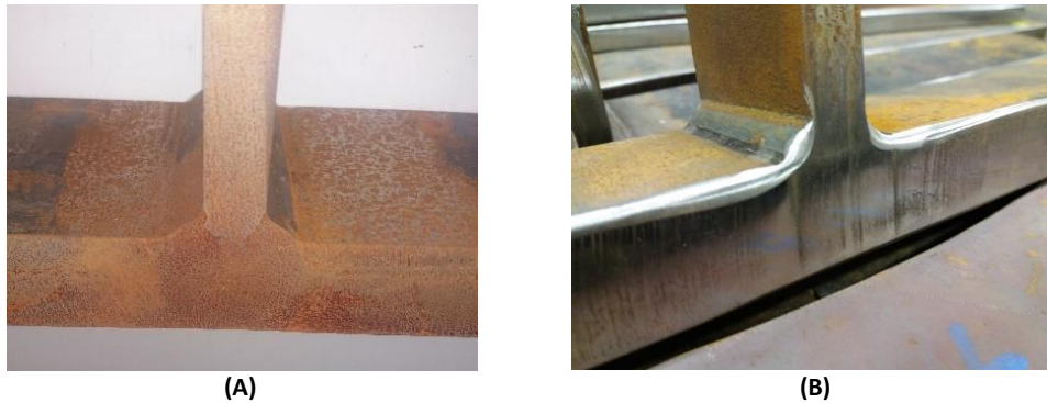
Abbildung 28: Schnittfläche – A: nach dem Wasserstrahlschneiden – B: mit Fächerscheiben geschliffen
