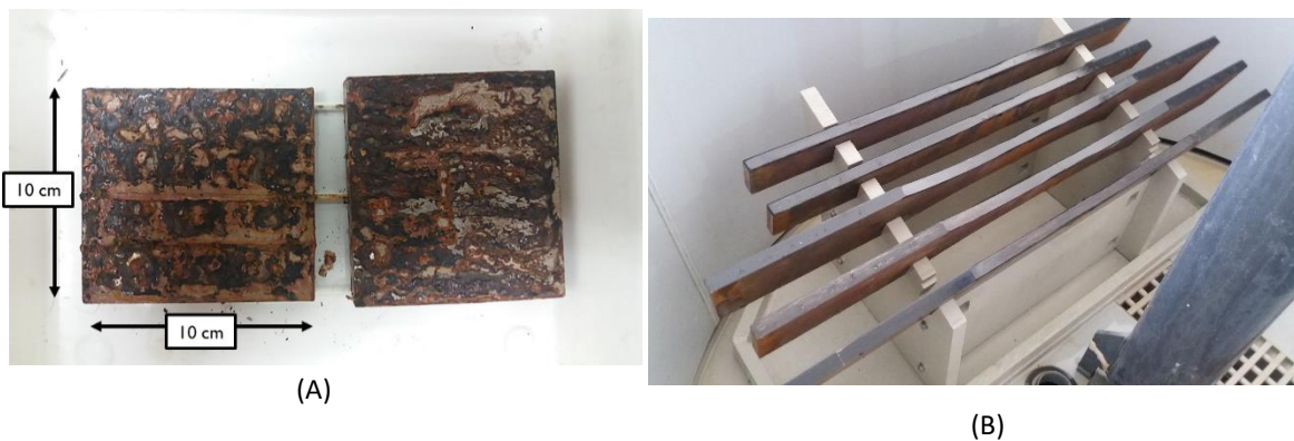
Abbildung 29: A: Kleinproben für die Untersuchung der Korrosionsschutzmittel – B: Versuchsaufbau in der SSN
