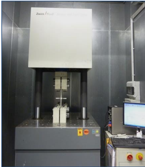
Abbildung 56: Ermüdungsversuch einer Kleinprobe mit der Zwick 400 HFP 5100
