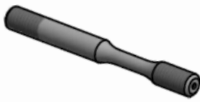
Abbildung 9: Probengeometrie für dynamische Zugversuche
