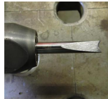
Abbildung 19: (a) HFH-Nachbehandlung der Schnittkanten – (b) Spezieller HFH-Pin für die Nachbehandlung von Kanten [52]
