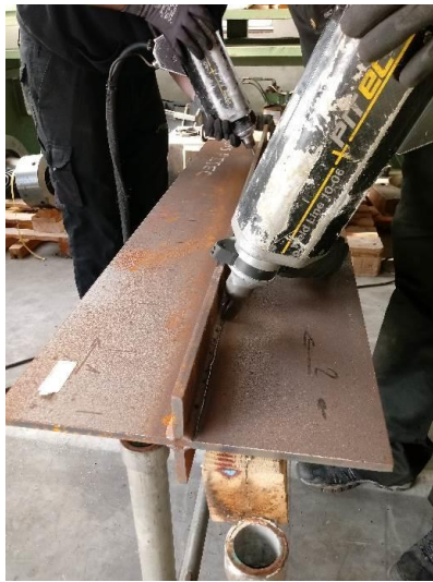
Abbildung 18: HFH-Nachbehandlung eines Mutterkreuzstoßes (a) und eines HEA260 Trägers (b) mit PITEC bzw. HiFIT
