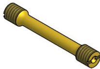
Abbildung 6: Probengeometrie für isotherme Zugversuche
