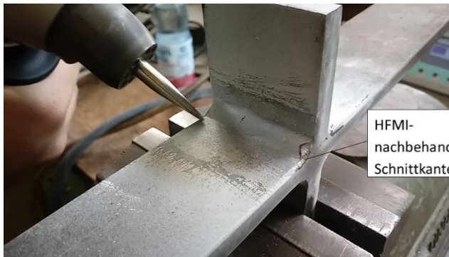
Abbildung 19: (a) HFH-Nachbehandlung der Schnittkanten – (b) Spezieller HFH-Pin für die Nachbehandlung von Kanten [52]
