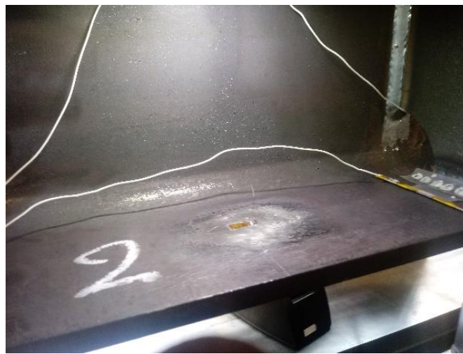
Abbildung 58: (a) FE Simulation des Ermüdungsversuchs an einem HEA 260 Träger (exemplarische Abbildung – Normalspannungen in y-Richtung) – (b) DMS Messung an der oberen Seite des unteren Flansches des HEA 260 Trägers
