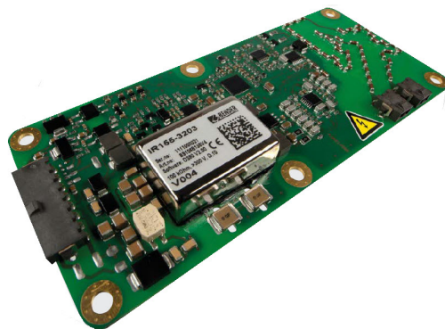
Abbildung 4.9 Der im FlexBat-System eingesetzte Isolationswächter (ISOMETER IR155-3203) [76]
