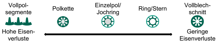
Abbildung 2-4: Verlustarten in Abhängigkeit der Blechpaketgeometrie (eigene Darstellung nach (Peter & Halwas et al. 2017))
