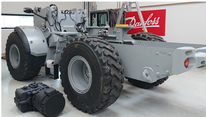
Abbildung 3.3: Bild nach Ausbau der alten Komponenten.
