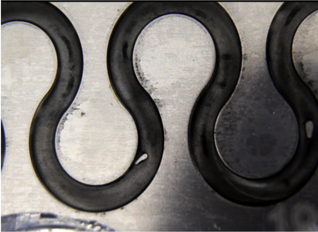
Abbildung 4.14: Transparenter PMMA-Deckel montiert auf die mikrostrukturierte Platte. Zu sehen sind Sedimente der Pd/C-Partikel im mäanderförmigen Mikrokanal (mit 0.3 Gew.-% Katalysator in Wasser bei 1,75 ml/min. (Abbildung übernommen aus [7])
