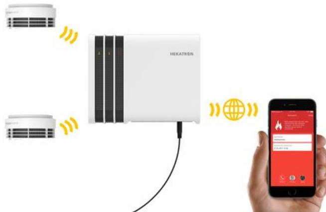
Abbildung 6: Links: funkvernetzte Rauchwarnmelder; Mitte: physisches Gateway als Kopplung zu IoT-Anwendungen beispielsweise auf Smartphone. Zusätzlich besteht eine akustische Schnittstelle (smartsonic) zwischen Rauchwarnmelder und Smartphone (hier nicht dargestellt), über die Daten ausgelesen werden können [29]
