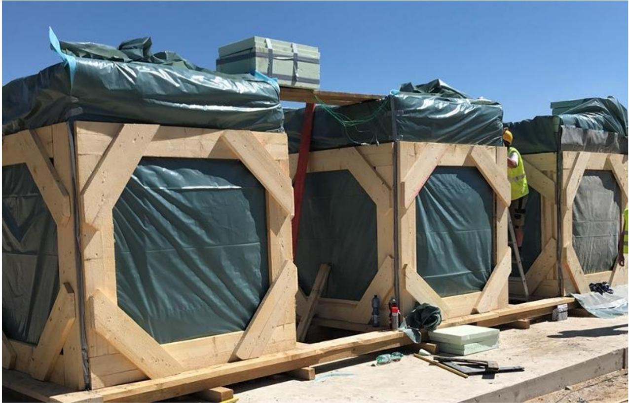
Abb. 3: Probelöcke mit jeweils vier Nachbehandlungsvarianten (jede Seitenschalung entspricht einer Variante)
