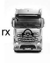
Abbildung 2.12: Hauptbewegungsrichtung des „Wankens“ am Beispiel eines Actros aus [27]
