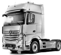
Abbildung 2.4: Actros 4x2 Sattelzugmaschine [27]
