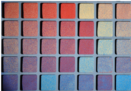
Abbildung 5.6 Ausschnitt eines Setzkastens befüllt mit händisch angefertigten Mischproben aus verschieden eingefärbten Quarzsanden.
