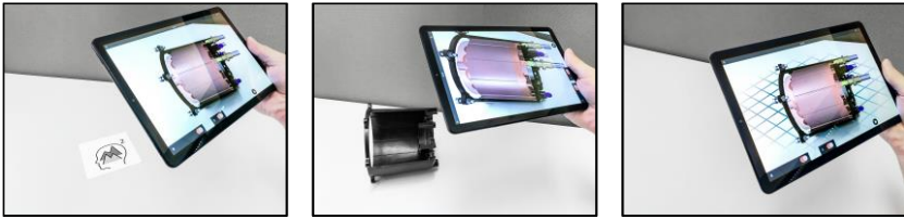
Abbildung 2.54: Geometrische Registrierung eines virtuellen Modells auf Basis von markerbasiertem Tracking mit 2D-Marker (links), 3D-Marker (Mitte) und markerlosem Tracking (rechts), Bilder aufgenommen im IPEK XR-Lab
