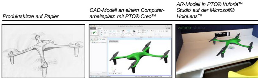
Abbildung 5.8: Verwendete alternative Produktmodelle eines Quadropters nach Reinemann, Fahl, Albers et al. (2019, S. 41)
