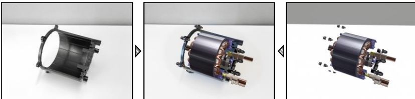
Abbildung 2.48: Überlagerung der realen Umgebung (links) durch virtuelle Objekte (rechts) zur Augmented Reality (Mitte), Bilder aufgenommen im IPEK XR-Lab 3
