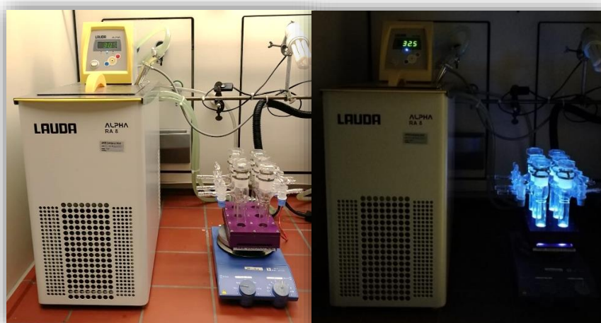
Abbildung 68: Belichtungsapparatur. Thermostat, Rührer, Gestell für Schlenkrohre und LEDs.
