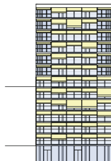
Abb. 50 Schematische West-Ansicht, ohne Maßstab, Idee eines außenliegenden Sonnenschutzes als einheitliches Kleid für den hybriden Baukörper
