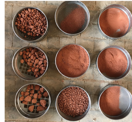
Sieblinien der Rest- und Nebenprodukte © Angelina Amann
