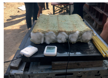
Mit Cellulosefasern befüllte und für die Messung vorbereitete Platte
