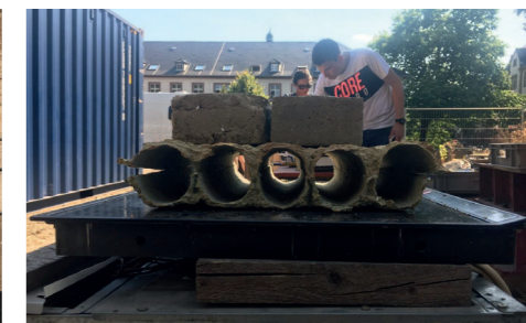
Verleimen der Halbschalen
