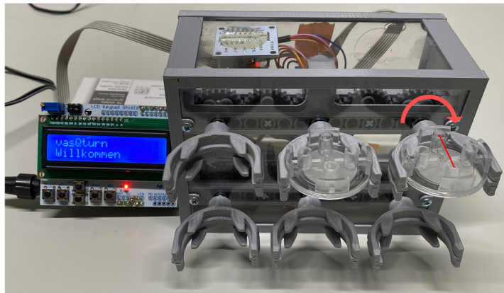
Abbildung 26 Darstellung des vasQturns mit zwei vasQchips zur Besiedlung. Schematisch in Rot dargestellt ist die Lage des Mikrokanals sowie die Drehrichtung der vasQchips.
