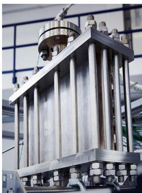
**Abb. 2.9:** Mikrostrukturierter Reaktor von Ineratec. Bild entnommen aus [78]. Der Katalysator wird in Form eines Festbetts eingebracht. Die Kühlung des Reaktors erfolgt mittels Verdampfungskühlung. Synthesegas und Kühlmedium (siedendes Wasser unter Druck) werden von außen betrachtet im Kreuzstrom durch den Reaktor geleitet.
