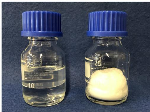
**Abb. 3.4:** Anfallende bei Raumtemperatur flüssige und feste Produktphasen bei einem integrierten FT/HC-Versuch. Die Flüssigphase setzt sich aus einer wässrigen und einer öligen Phase zusammen, die die mittelkettigen Kohlenwasserstoffe enthält. Die Festphase besteht aus den langkettigen Kohlenwasserstoffen der Wachsfraktion.
