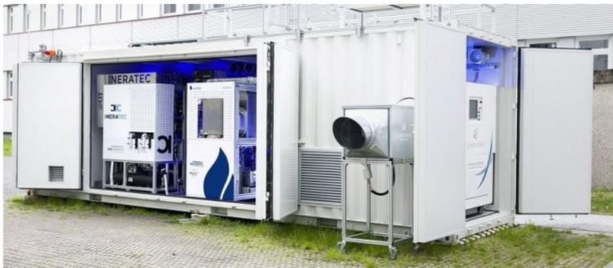
**Abb. 2.5:** Container mit einem vollintegrierten System aus DAC, SOEC, FTS und HC zur Herstellung synthetischer flüssiger Kraftstoffe. Aufbau und Betrieb durch die Projektpartner Karlsruher Institut für Technologie (KIT), Ineratec, Climeworks und Sunfire im Rahmen des Kopernikus Projekts „Power-to-X“ des BMBF. Bild entnommen aus [48].
