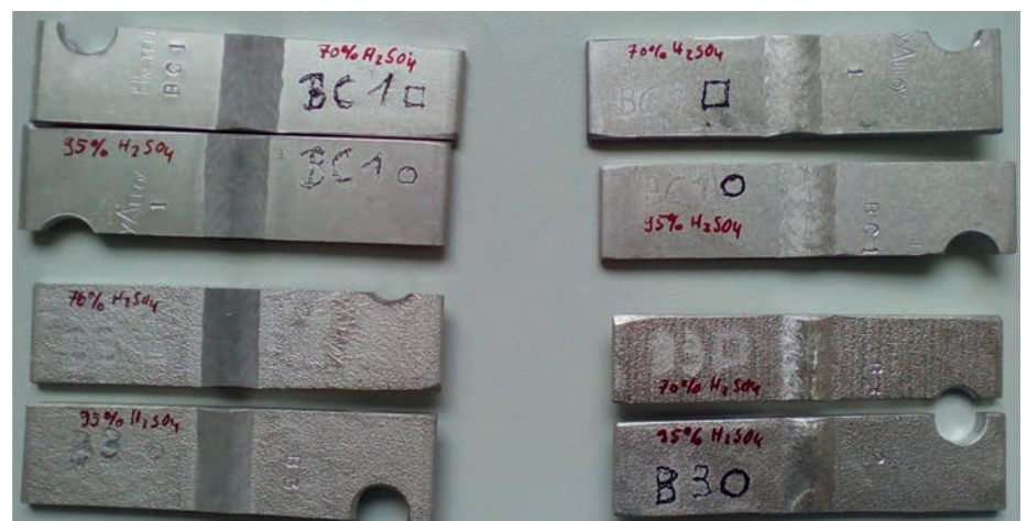
Abb. 6: Proben nach dem Korrosionstest im Lieferzustand (links) und nach Wärmebehandlung (rechts) bei T = 1100 °C, t = 4 h, der Werkstoffe Hastelloy BC-1 (oben) und Hastelloy B3 (unten)
