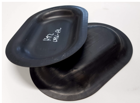
Abbildung 3.4: Zugeschnittene hybride 3D-Bauteile mit den Maßen aus Abb. 3.3 [225]*.
