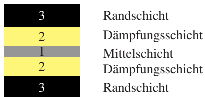
Abbildung 5.1: Schematischer Aufbau eines symmetrischen fünfschichtigen Laminats zur Modellierung mit dem analytischen RKU-Modell. Das Laminat ist aus drei verschiedenen Einzelschichten aufgebaut.
