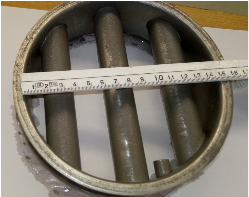
Abbildung 3.14: Ansammlung der Edelstahlpartikel auf dem Magnetrost, in dem sich keine Magnetstäbe während der Versuchsdurchführung befanden
