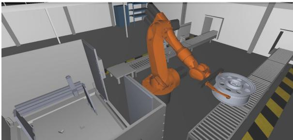
Vollautomatisierte Produktionszelle zum Fräsen von Felgen, Logistik- & Robotersimulation
