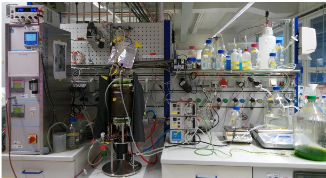
Abbildung 2-7: Photobioreaktor System BioEngineering, welches für Kultivierungsexperimente im Labormaßstab eingesetzt wurde. Obiger Aufbau erlaubt eine Kultivierung im kontinuierlichen Betrieb. (A) Schematischer Aufbau, (B) Fotografie. Quellen: Eigene Aufnahme und Zeichnung.
