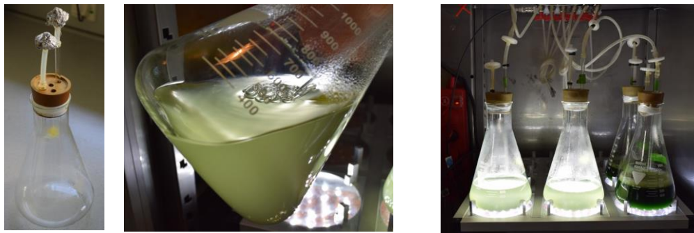
Abbildung 2-4: Begaste Weithals-Erlenmeyerkolben zur Mikroalgenkultivierung auf einem beleuchteten Schüttler. Quelle: eigene Aufnahmen.
