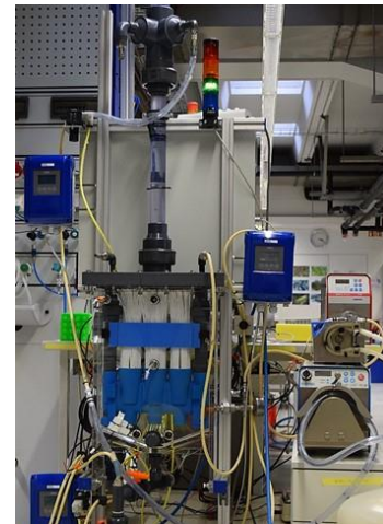
Abbildung 3-2: R&I-Fließschema der Filtrationsanlage Harvester (A) sowie Fotos der Anlage inkl. Peripherie mit einer Algensuspension (B) beziehungsweise Wasser (C) gefüllt. Quelle: eigene Zeichnung und Aufnahmen.
