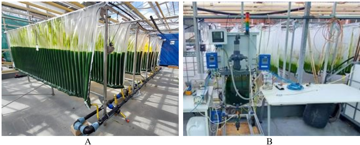
Abbildung 5-4: Kontinuierliche Kultivierung von Desmodesmus sp. in einem synthetischen Abwasser in miteinander verbundenen „Beutel“-Photobioreaktoren (Phytobags) (A) mit externer Membraneinheit ( Harvester ) (B) zur Realisierung eines MPBR. Durch die Kopplung von fünf Phytobags wurde ein Reaktorvolumen von 1000 L realisiert. Entlang des Reaktorbodens ermöglicht ein poröses Rohr die Begasung des Reaktorinhaltes zur Durchmischung sowie zum Gasaustausch. Die Beleuchtung des PBR-Systems erfolgt über natürliches Sonnenlicht, Schattenbereiche wurden mit künstlicher Beleuchtung behoben. Ein an das Prozessleitsystem des Harvesters angeschlossener Trübungssensor erlaubt die prozessbegleitende Quantifizierung der Biomassekonzentration im PBR. Quelle: Aufnahmen von Rohit Dey.
