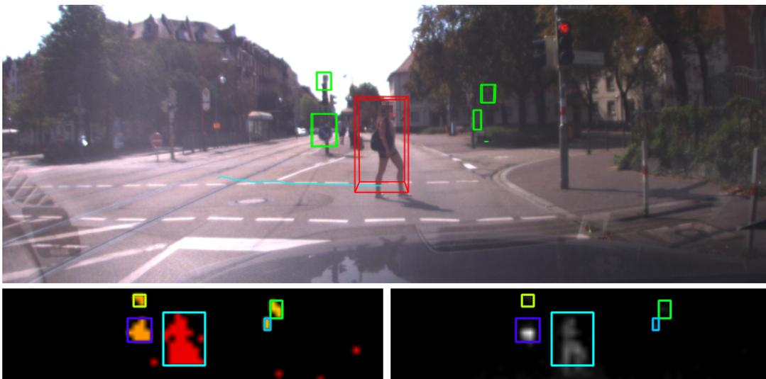
Abbildung 2.14: Objektdetektion und Klassifikation auf Basis eines Tiefenbilds einer TOF-Kamera und eines Videobilds. Die in das Videobild projizierten Objekthypothesen werden klassifiziert (rot: Fußgänger).
