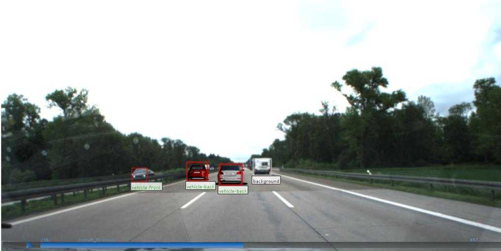
Abbildung 2.11: Videobasierte Detektion von Autos auf einer semivirtuellen Autobahnscene
