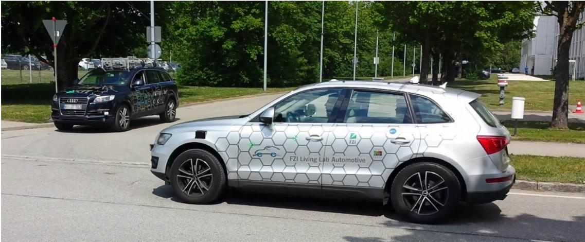
Abbildung 7.5: Demonstrationsszenario – Detailansicht. Das schwarze Fahrzeug gewährt erst sehr spät Vorfahrt. Das automatisierte, silberne Fahrzeug soll sich der Kreuzung entsprechend defensiv nähern.
