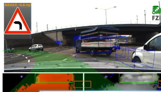
(c) Verzögerung aufgrund einer Kurve. Das Fahrzeug vor dem Ego-Fahrzeug wird mit Hilfe der Spurinformati- on als nicht relevant für die ACC Funktionalität eingestuft.
