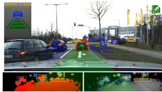
(b) ACC Funktionalität auf ein vorausfahrendes Fahrzeug. Das relevante Fahrzeug wird durch einen roten Rahmen markiert.
