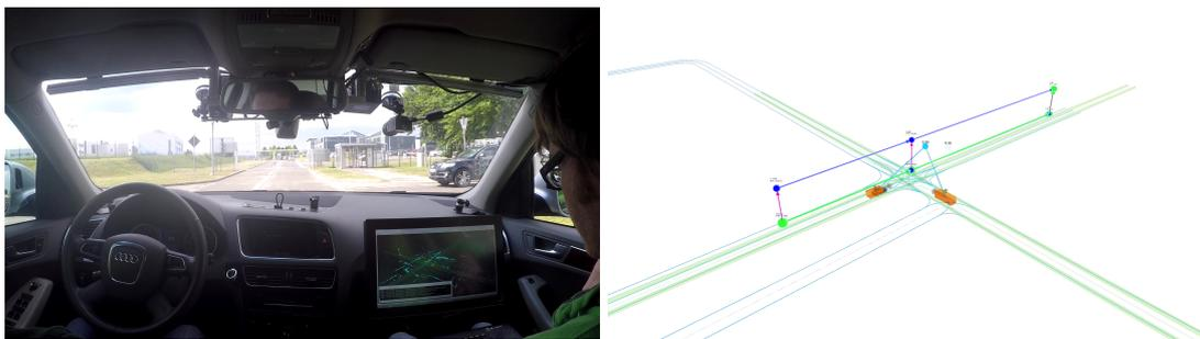
(c) Das Fahrzeug von rechts bremst stark ab. Es wird wieder regelkonformes Verhalten prädiziert, **ego** (von links) kann die Kreuzung passieren.
