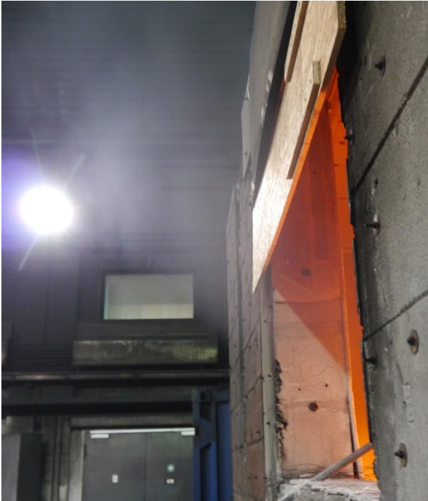
Abb. 26: Rauchaustritt aus Versuchsraum durch teilweise verdeckte Fensteröffnung
