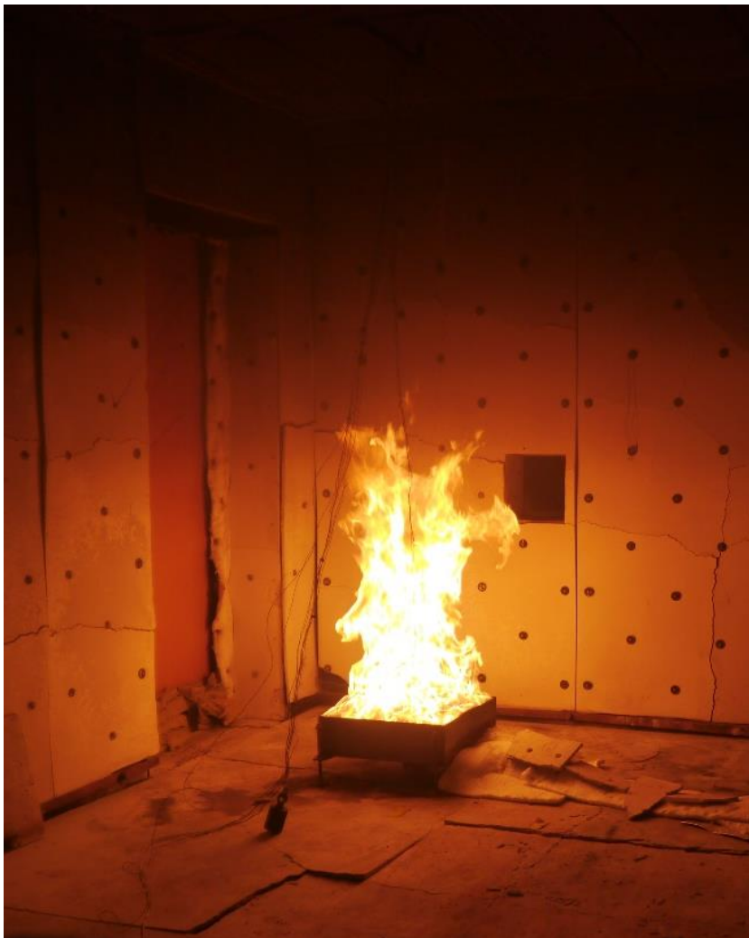
Abb. 25: Kiesbettbrenner-Flamme bei 200 kW, Betrieb mit LPG
