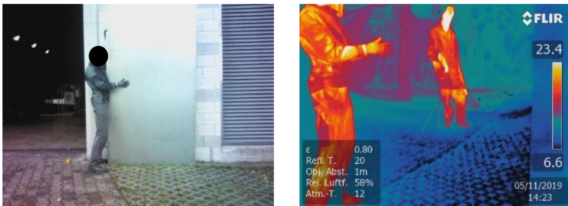
Abb. 12: Reflexion einer Edelstahlplatte. Links herkömmliche Aufnahme mit Digitalkamera, rechts Aufnahme mit der WBK
