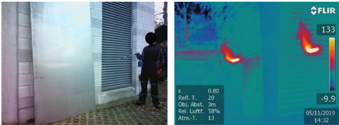
Abb. 13: Reflexion einer Edelstahlplatte. Links herkömmliche Aufnahme mit Digitalkamera, rechts Aufnahme mit der WBK
