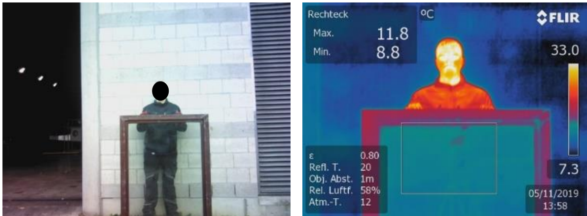
Abb. 9: Transmission einer Fensterglasscheibe. Links herkömmliche Aufnahme mit Digitalkamera, rechts Aufnahme mit der WBK
