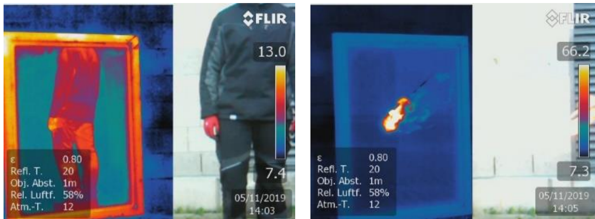
Abb. 11: Reflexion einer Fensterglasscheibe. Links eine Person, rechts die Flamme des Gasbrenners. Aufnahmen mit der WBK
