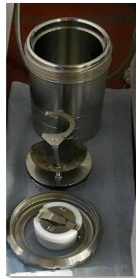
**Abbildung 20** Kalorimeterbombe, Zündvorrichtung, Behälter, Dichtung
