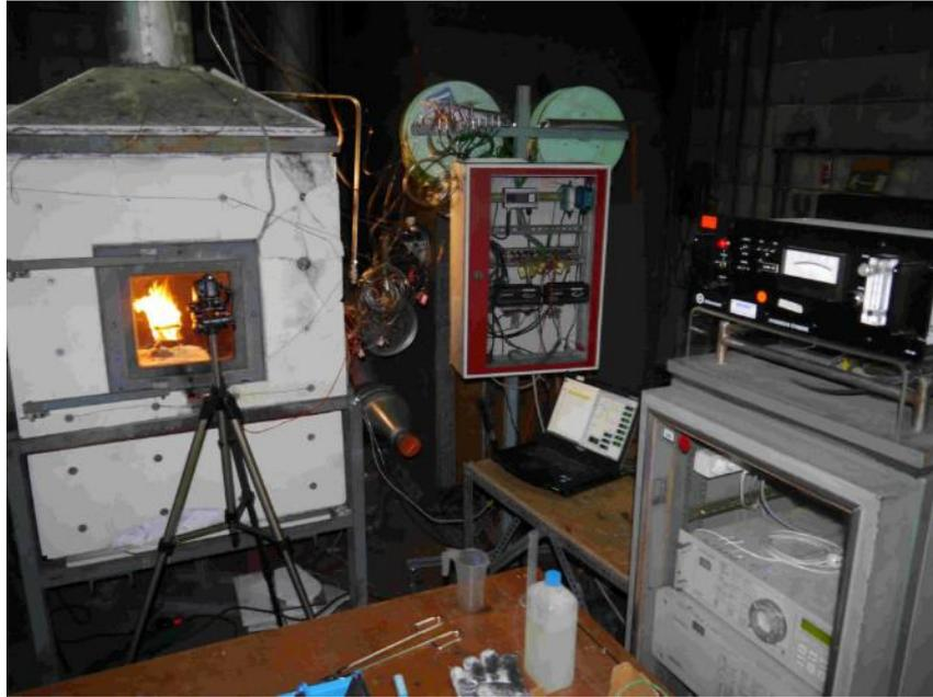
**Abbildung 22** Messkammer nach Vorbild DIN EN 13823
