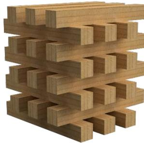
**Abbildung 11** Prinzipskizze Holzkrippen (selbst erstelltes CAD Design)
