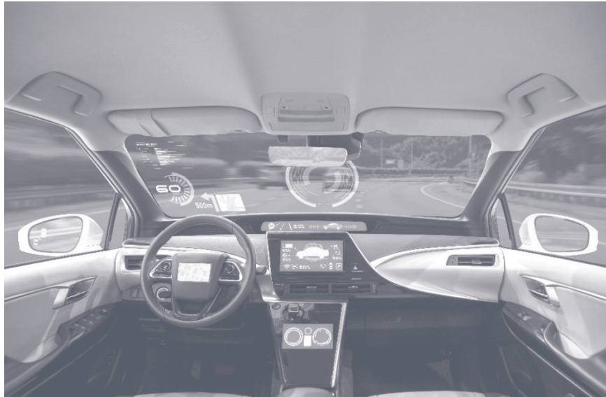
Abb. 2.5 Head-up-Display in einem Automobil
