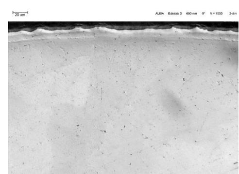
650 mm: : ZrO<sub>2</sub> 6 µm; α-Zr(O) 4 µm
