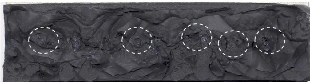
Abbildung 4.57: Exemplarische Bruchfläche bei  $T = RT$  und Nenndehnrate:  $0,416 \text{ mm}^{-1}$  nach 42 Tagen Wasserlagerung bei  $T = +45 \text{ }^\circ\text{C}$  ohne Rücktrocknung (Geometrie  $24 \text{ mm} \times 6 \text{ mm} \times 100 \text{ mm}$ , Zug, Werkstoff SGA) (Quelle: eigene Aufnahme)
