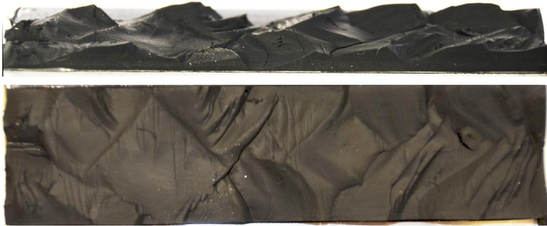
Abbildung 4.48: Exemplarische Bruchfläche bei  $T = RT$  und Nenngleitrate:  $0,416 \text{ mm}^{-1}$
