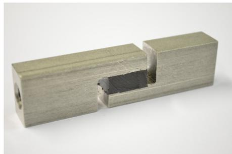
Abbildung 4.22: Foto der verwendeten Zugscherprobe
