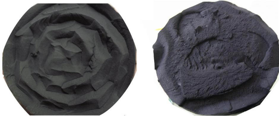
Abbildung 2.7: Veränderung des Bruchbildes eines Kopfzugprobe infolge der Erhöhung der Testgeschwindigkeit (links:  $v_t = 5$  mm/min, rechts:  $v_t = 3$  m/s, Klebstoff DC993)
