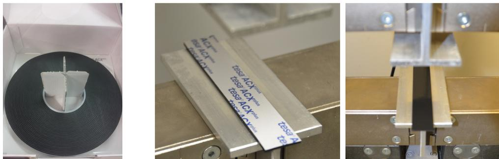
Abbildung 4.29: Anlieferungszustand (links) und Applikationsversuche mit Aluminiumprofilen (Mitte und rechts)
