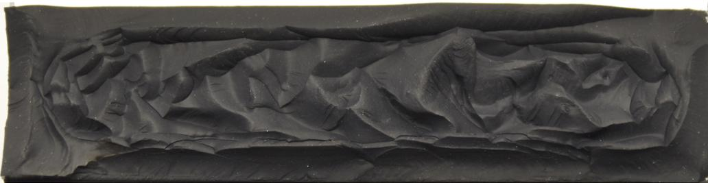
Abbildung 4.55: Exemplarische Bruchfläche bei  $T = +80 \text{ }^\circ\text{C}$  und Nenndehnrate:  $0,416 \text{ mm}^{-1}$  (Geometrie  $24 \text{ mm} \times 6 \text{ mm} \times 100 \text{ mm}$ , Zug, Werkstoff SGA)
