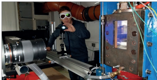
Abb.: Justage der Laseroptik für die Strömungsmessung an einem Einhubtriebwerk für den SFB/TRR 150; Foto: IFKM/ Heiko Kubach
