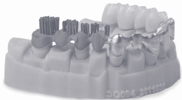
Abb. 1 Mit dem Verfahren des selektiven Lasersinterns additiv gefertigte Brücke
