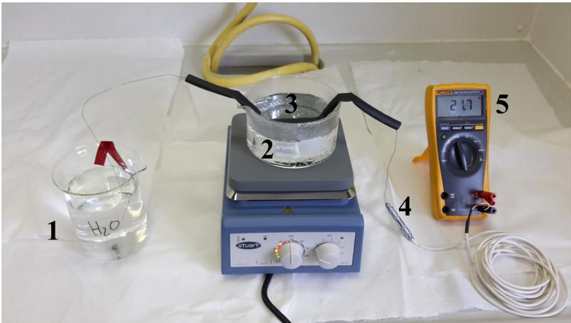
Abbildung 6.11: Versuchsaufbau zur Überprüfung der Steckverbindungen auf Wärmeempfindlichkeit.
