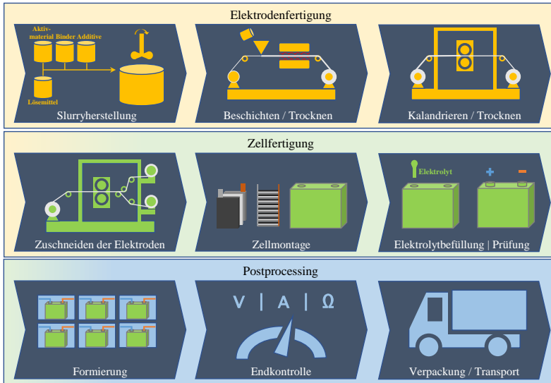
Abbildung 2.6: Schematische Darstellung der einzelnen Fertigungsschritte, nach [46] und [47]
