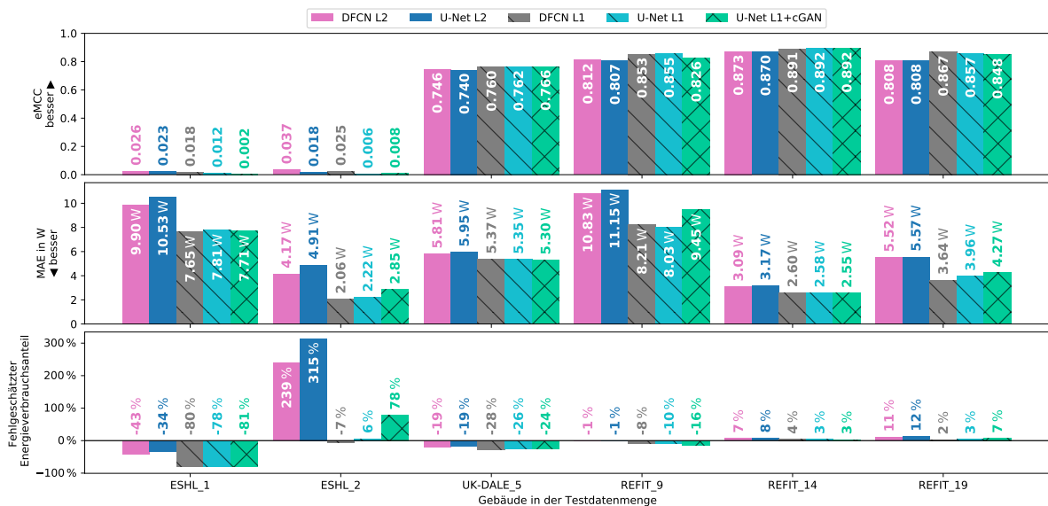
Abbildung A.13: Fehlermetriken bei der Disaggregation von Wasserkochern mit der U-Net-Architektur.
