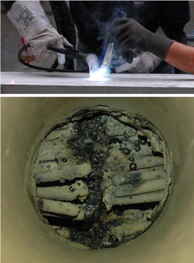
Abb. E-5: Versuchsdurchführung - Schädigung der Litzendrähte mit Schweiß-Trennelektroden (oben) sowie Schadensbild (unten)
