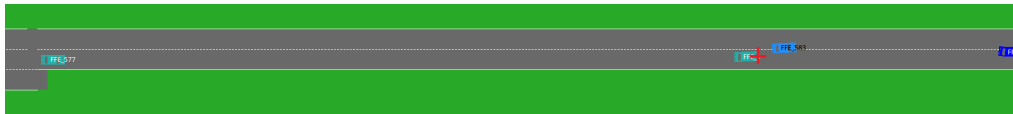
Abbildung 6.24: Die kritische Situation wird durch eine Vollbremsung des Testfahrzeugs und eine Beschleunigung und Spurwechsel des Vorderfahrzeugs entschärft
