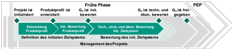
Abbildung 2.14: Die Frühe Phase der PGE - Produktgenerationsentwicklung nach Albers, Rapp et al. (2017), Albers, Heitger et al. (2018), Albers, Peglow et al. (2019)
