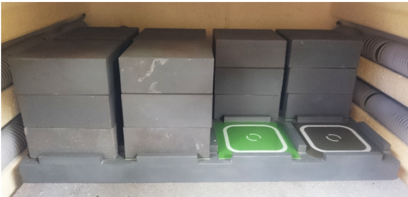
Abbildung 3.8: Foto der Lötvorrichtung im Ofen
