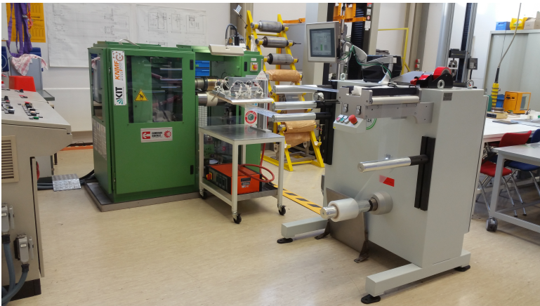
Abbildung A.22: Abbildung der kompletten R2R-Abformanlage inkl. Abwickler sowie Vorheizung und Prägekalander
