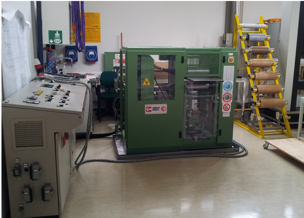
Abbildung 4.1: Laborkalender am IMT als Kernelement der R2R-Prägeanlage
