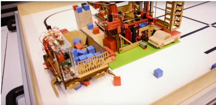
Abbildung 9.10: Im Rahmen von MSuP entwickeltes System. Die blauen und roten Klötze müssen aufgesammelt und vom entwickelten System zu Türen aufgestapelt werden. Bildschirmfoto von Video der MSuP Abschlussveranstaltung (KIT - Karlsruher Institut für Technologie, 2020).
