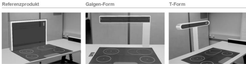
Abbildung 2.58: Referenzprodukt als Bestandteil physisch-virtueller Prototypen bei der Validierung von Lösungskonzepten in einer Augmented-Reality-Umgebung. Das Kochfeld wird physisch dargestellt, verschiedene Abzugsformen werden virtuell modelliert (Reinemann et al., 2018, S. 11).
