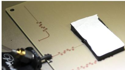
(b) Antenne mit aufgelegtem Absorber als Abschluss
