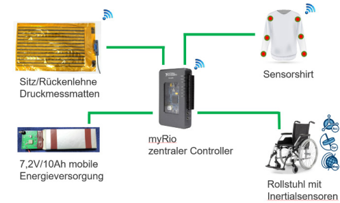
Abbildung 1: Konzept eines sensorgestützten Aktivitätsmonitoring für Rollstuhlfahrende
