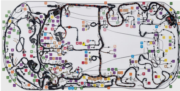
Abbildung 3.5: Bordnetz einer E/E-Architektur [MBB18]
