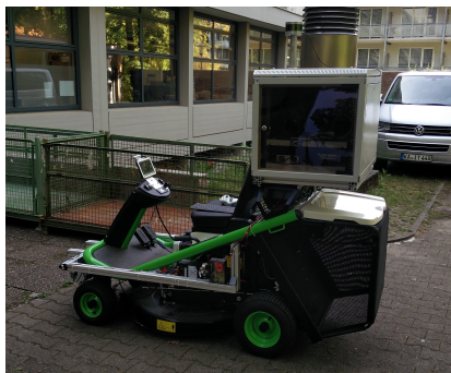
Abbildung 5.1: Der als Basis verwendete elektrisch angetriebene Aufsitzrasenmäher der Firma ETESIA
